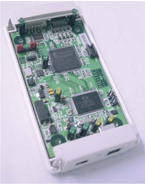
Zum Testen von Hardware-Bausteinen: Der von HEITEC entwickelte Adapter.
